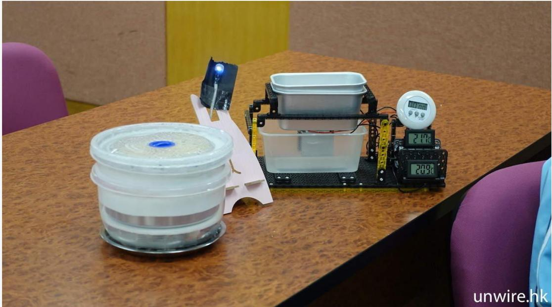
▲第一代的加熱食物盒（右）明顯看到很多電線及電子零件，體積亦較大。
