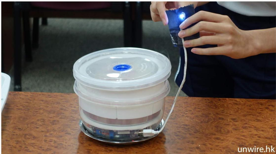
▲食物盒底部的托盤盛載冰水，與盒內發出的熱力造成溫差來發電，溫差愈大，電力愈強。
