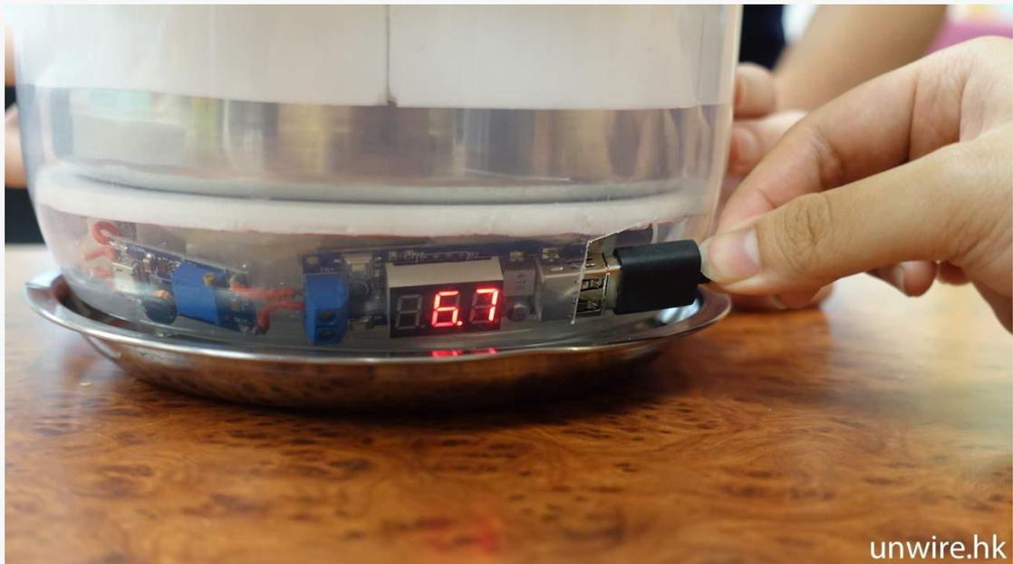
▲圖中最左邊的電子零件是「電流放大器」，從電筒拆出來；中間的是電流穩定器，接駁 USB 接口。
